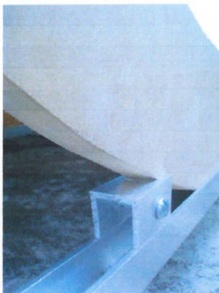
Figura 6.22 – Dispositivo de fixação do coletor
